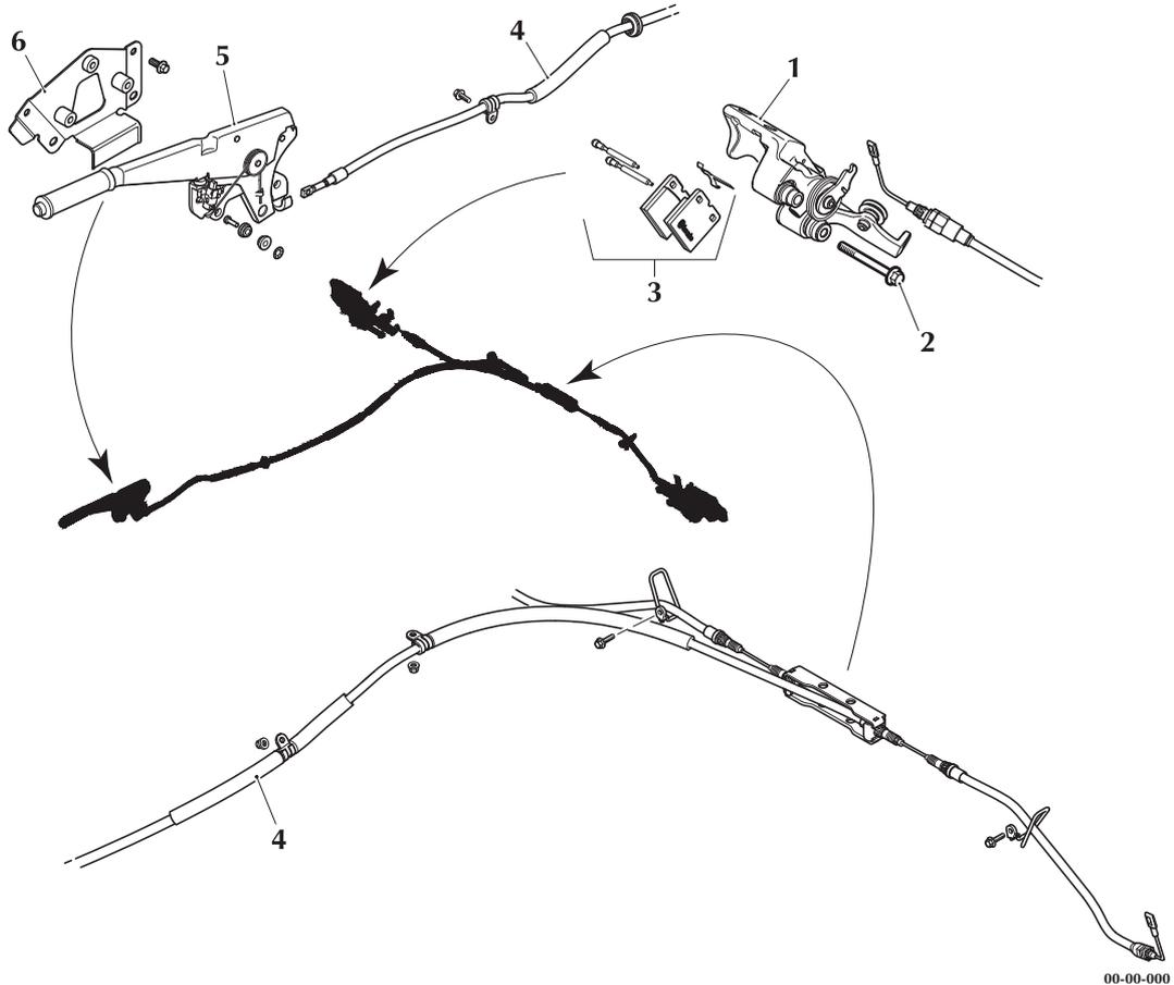
**Figure 06.05.01 - Handbrake Assembly**
