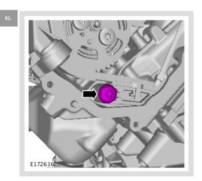
Remove the timng chain guide bolt.
